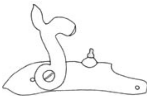
Llave de pistón. También puede apreciarse la chimenea.
