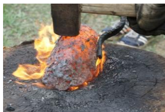
Рис. 9. Первичная проковка-сварка железной крицы.
