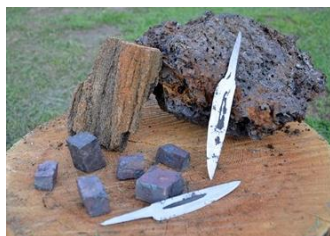
Рис. 11. Руда, крица, кричное железо, клинки якутских ножей.
