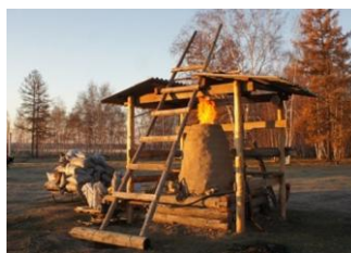
Рис. 8. Якутская печь для выплавки железа из руды.
