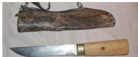
Рис. 2. «Поясной нож». Длина клинка 17 см, ширина 2. 8 см, длина рукояти 13 см, ширина 3. 3-3. 9 см. Ножны из шкуры нерпы. Селение Парень, начало 70-х годов 20-го века.
